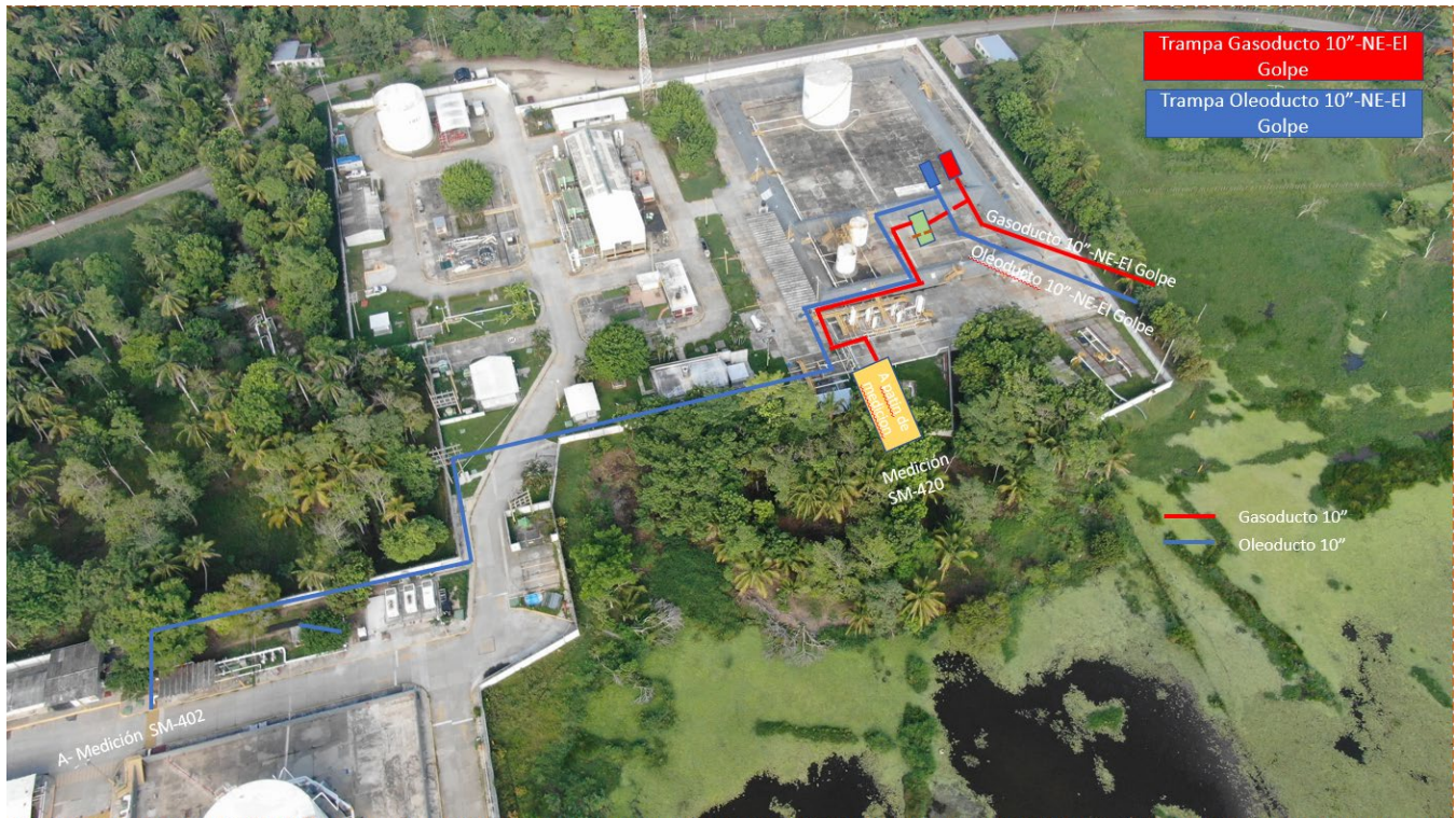
Figura A.5.- Trayectoria en área de procesos de la llegada del Gasoducto a medidores en Complejo Golpe
