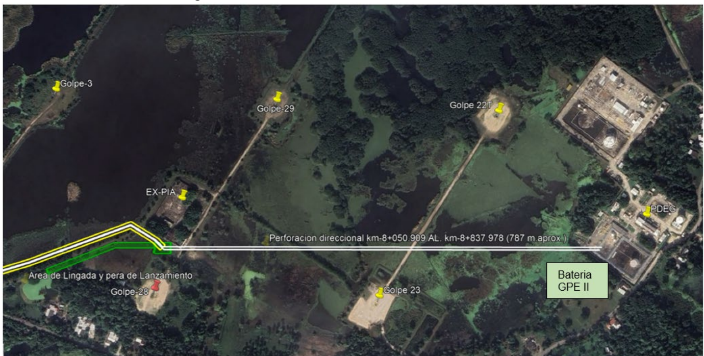
Figura A.2. Direccional: del km 8+055.435 al km 8+833.457
